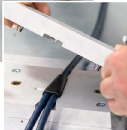
Selbst entwickeltes und gefertigtes Spritzgusswerkzeug für den Splitter des S25-Y-Subwooferkabels.
